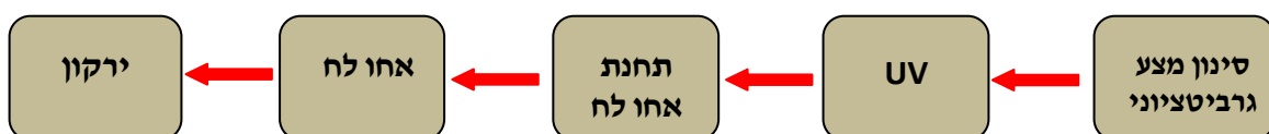
איור מס' 5: תהליך שילוב קולחי מט"ש כפר סבא הוד השרון במפעל גאולת הירקון
